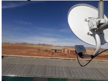
**Img.** Antena Parabólica montada con un equipo LDF5
