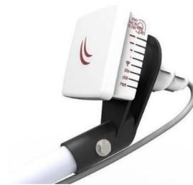
**Img.** CPE Cliente en 5ghz Mikrotik LDF5
