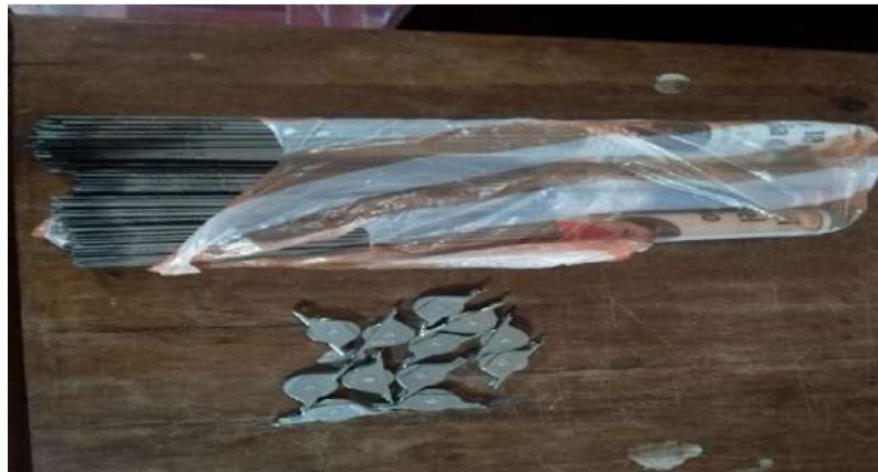
IMAGEN 3: Rueda para puertas corredizas (rodamiento) y electrodo 6013
