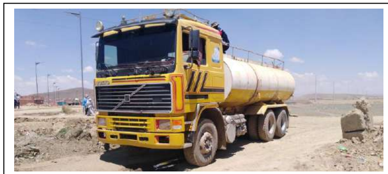
IMAGEN 1: REGADO CON CISTERNA
